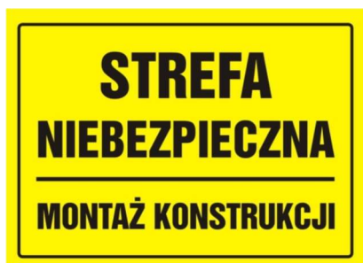
Rysunek 1 Oznakowanie strefy niebezpiecznej przy montażu konstrukcji
