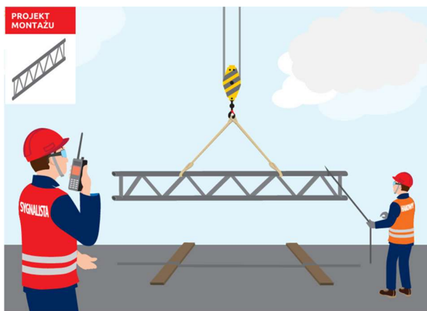
Rysunek 7 Stosowanie liny kierunkowej do asekuracji ładunku
