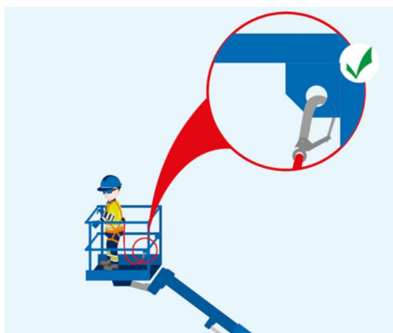
Rysunek 5 Zastosowanie podnośnika i szelek bezpieczeństwa
